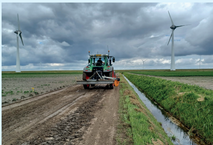
Figuur 1. en 2. Aanleg van een cascadegreppel met een schuif die is uitgerust met een schijf (links). De schijf werkt de grond omhoog, die vervolgens door de schuif over het pad wordt verdeeld. Links van het pad ligt al een greppel. De tweede greppel is aangelegd langs de sloot (rechts).
