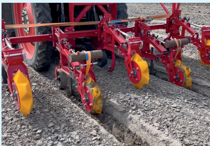
Figuur 1. De putjesrol laat een structuur achter in de bodem waarin afspoelend water kan blijven staan en infiltreren. Voor de rol maakt een woeltand de grond los. Op de foto wordt de putjesrol toegepast tussen leliebedden, waardoor met maar twee rollen wordt gewerkt.
