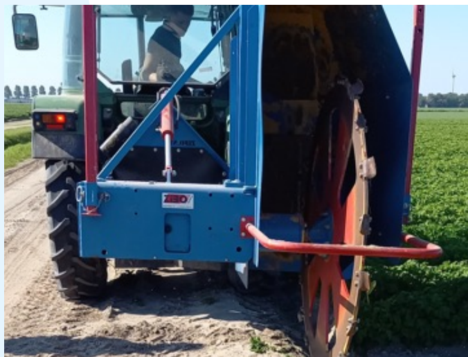
Figuur 9. Een kap op de sleuvenfrees voorkomt dat het zand over het gewas wordt gegooid
