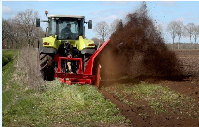
Figuur 8. Een sleuvenfrees zonder kap in werking binnen het project 'Perceelsemissie Drentsche Aa'
