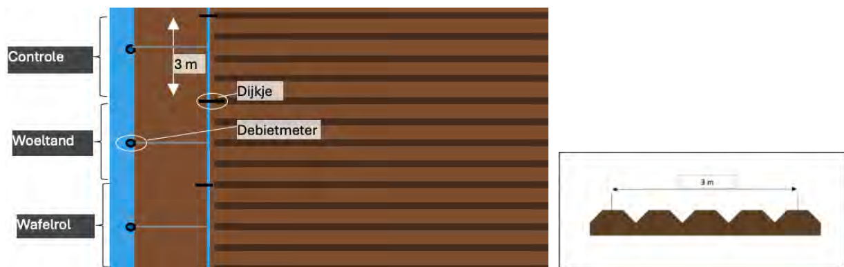
Figuur 3.2 Schematische opzet van de afspoelingsproef, deze opzet is zes keer herhaald (links).
