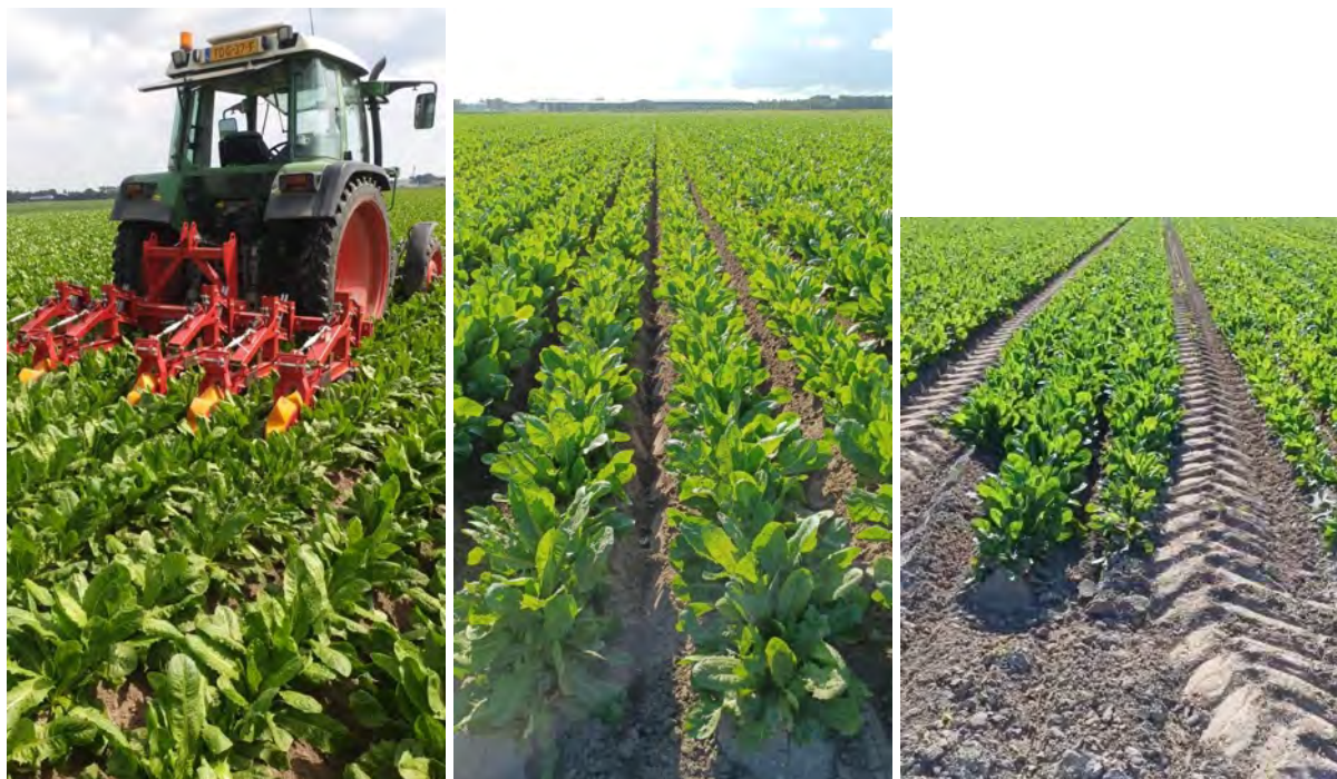
Figuur 4.8 De putjes worden aangebracht tussen de witlofruggen (links). De putjes kort na aanbrengen (midden) en het spuitspoor (rechts).
