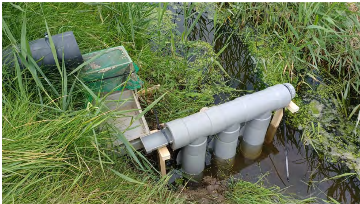
Figuur 6.2: Meetopstelling om afspoelend water vanuit de debietmeter op te vangen in een drietal monsternameflessen.
