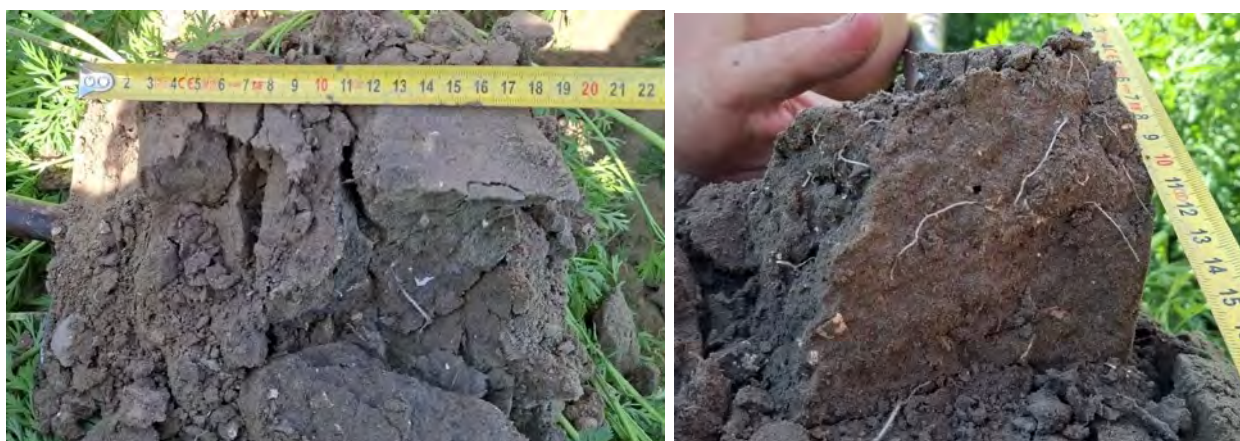
Figuur 3.9. Breukvlak op 10 cm tussen de ruggen op 10 cm diepte (links) Wortels groeien horizontaal over dit breukvlak (rechts).
