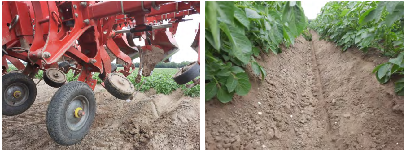
Figuur 2.8 Links: Machine voor schoffelen en aanaarden. Rechts: de open structuur van de rug na deze behandeling.
