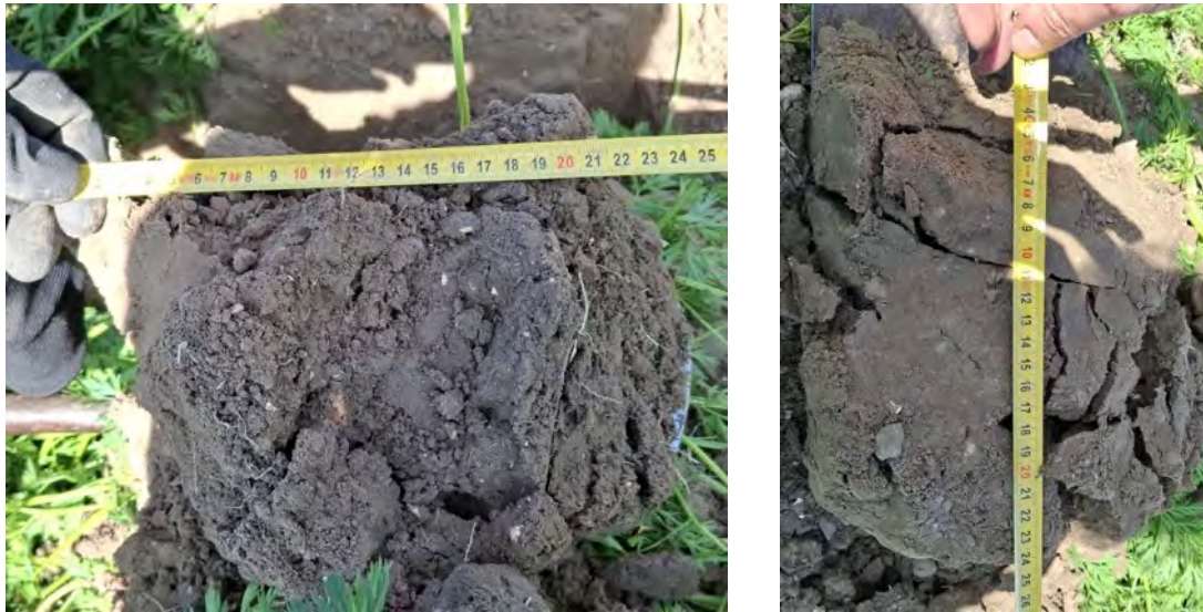
Figuur 3.12 In de ene kluit was tussen de ruggen een verdichte laag te zien tussen 13 en 17 cm diepte (links). In de andere kluit zagen we tussen de ruggen een scherp breukvlak op 11 cm diepte (rechts).
